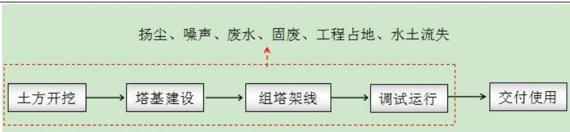
图 4-2 集电线路施工工艺流程图
