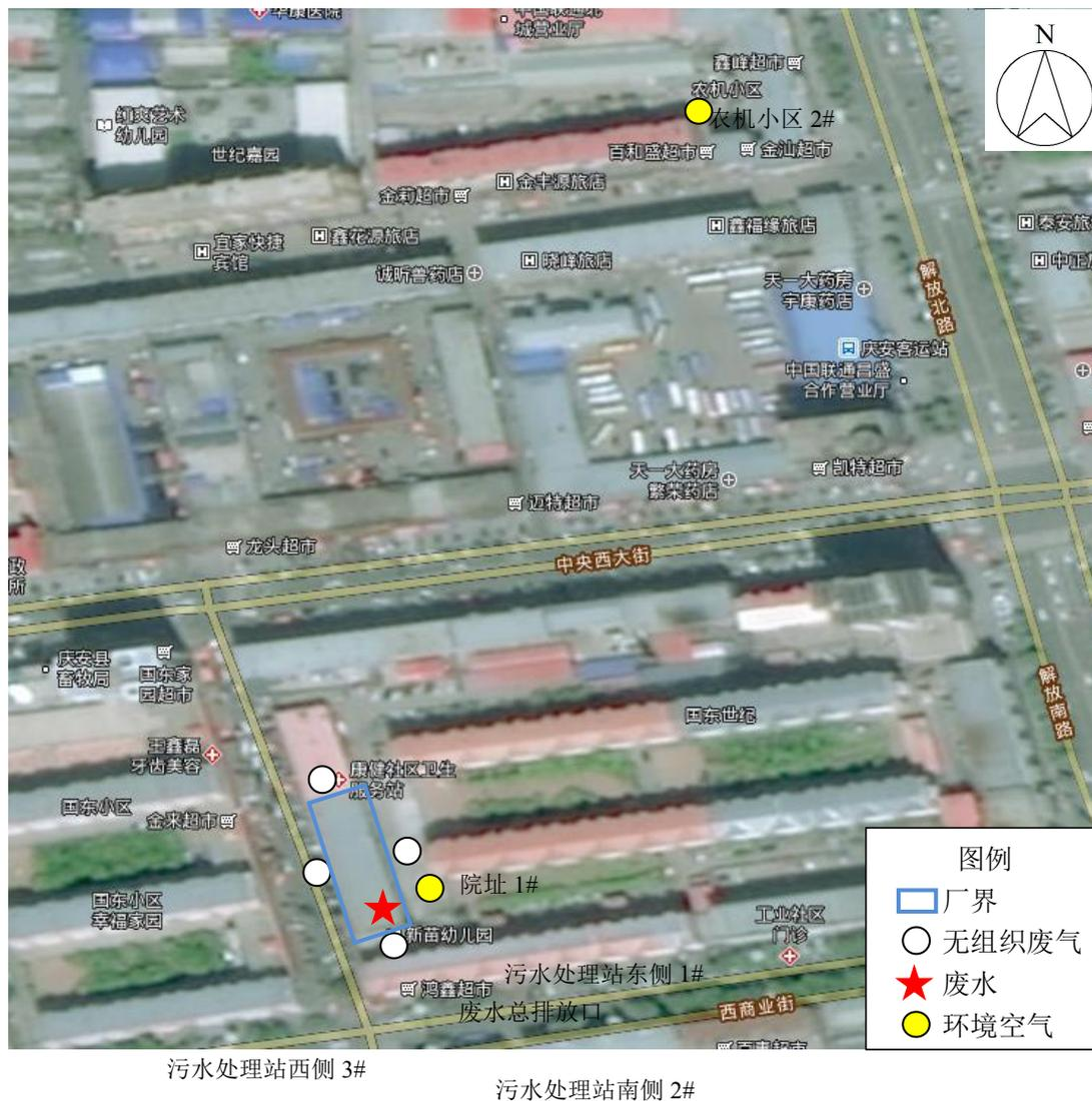
图 1 本项目环境空气、无组织废气、废水监测点位示意图
