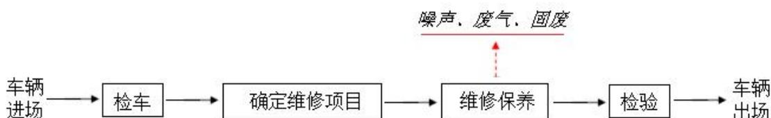
图2-2 汽车维修工艺流程图及产污节点
