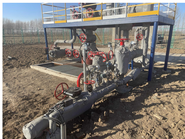
气井井口密闭，设备阀门密封
